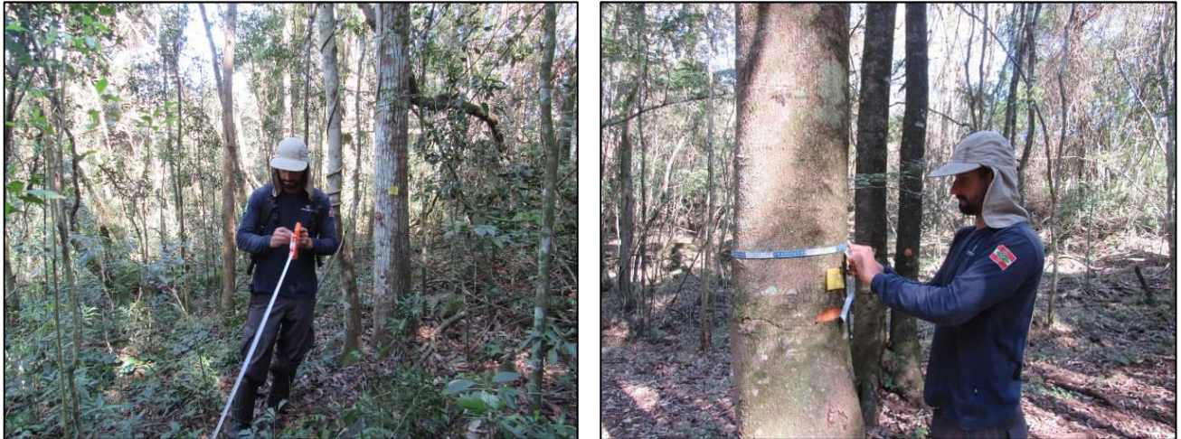
Figura 12.4. Detalhe do recolhimento da trena para a marcação da picada central da unidade amostral (à esquerda) e a medição do CAP com o auxílio de uma fita métrica (à direita).
