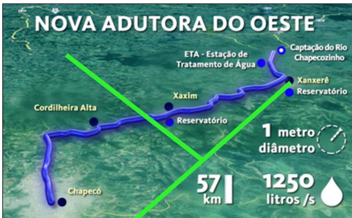
Figura 9.1. Representação ilustrativa do traçado previsto à Nova Adutora do Oeste (ou Adutora Rio Chapecozinho, em azul) em relação ao traçado aproximado das LTs sob análise (em verde claro). Fonte: adaptado de CASAN, 2017.
