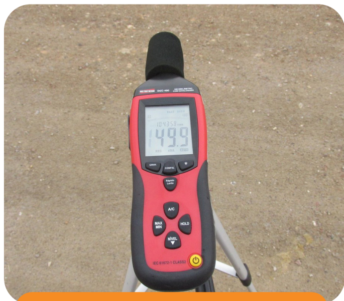
Decibélmetro: equipamento para fazer medição de ruídos.
